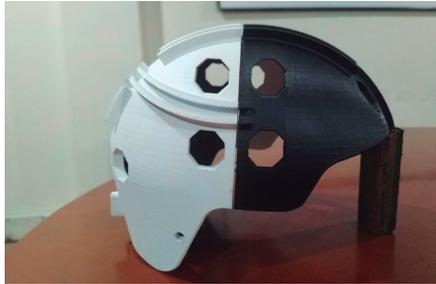
**Figura 6.** Impresión de casco en impresora 3D.
